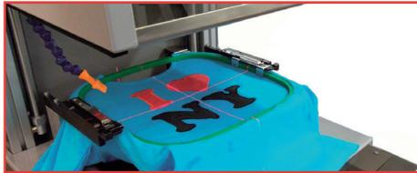
Il supporto telaio con software dedicato abbina il taglio e l'incisione laser alle macchine da ricamo per eseguire lavorazioni combinate.
